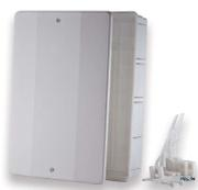
**209R** Cassetta in materiale plastico rigido per installazione da incasso completa di coperchio e supporti. Altezza 30 cm Profondità di installazione 8,5÷11,5 cm Larghezza 35-43-53-63 cm
