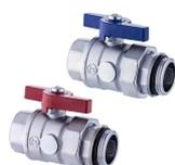
**305NK/1** Coppia di valvole a sfera a passaggio integrale con bocchettone a sede piana ed attacco collettore con tenuta O-ring. Disponibili nelle misure 3/4" ed 1"
